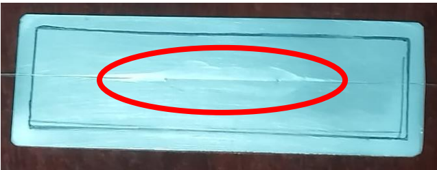
Fig. 5. Compuesto de lofina sobre la fibra óptica y la placa de aluminio
