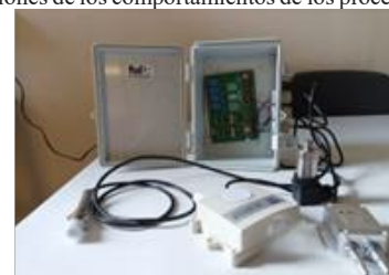
Fig. 1. Tarjeta diseñada para la adquisición de datos
