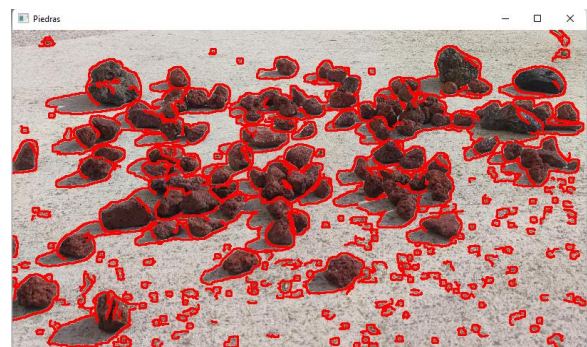
Imagen 1. Imagen segmentada para la detección de elementos rocosos
