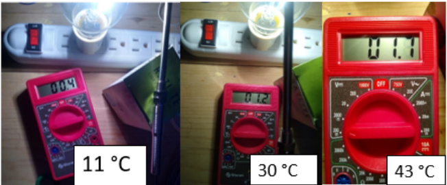
Fig. 7 Mediciones de la señal eléctrica (temperatura)
