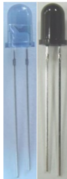
Fig. 3. “L.E.D.” infrarrojo (azul), Fotodiodo Infrarrojo (negro).
