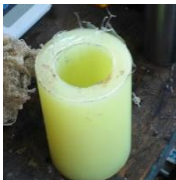
Figura 2. Barra de poliuretano hecha con el proceso descrito en la metodología
