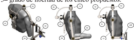
Figura 14. Mecanismo propuesto para el movimiento de la pronosupinación en el antebrazo.
