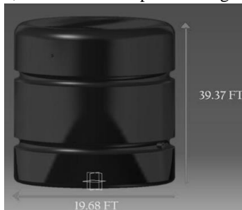
Fig. 5. Depósito de agua suavizada.
