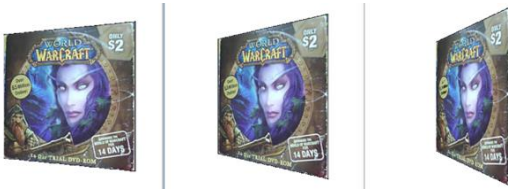
Figura 2. Imágenes generadas para la medición de la repetibilidad para la Figura 1.b. Corresponden a una perspectiva de 20, 40 y 60 grados.
