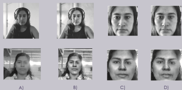
Fig. 2 Proceso del reconocimiento facial. A) Imagen de entrada, transformada a escala de grises. B) Ecuilización del histograma. C) Se localiza el rostro, se recorta y se normaliza a una dimensión de 300 x 300 ppp. D) Localización de puntos de interés.
