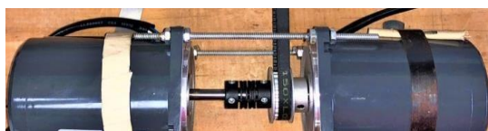
Fig. 15. Acoplamiento de los motores de inducción.
