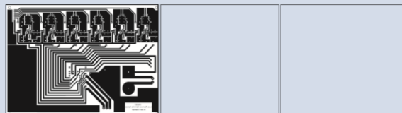
Figura 3. Construcción de inversor utilizando Modulo de IGBT FP30R06W1E3
